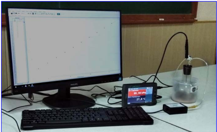
Рис. 5. Експериментальна установка для вивчення ізохорного процесу
