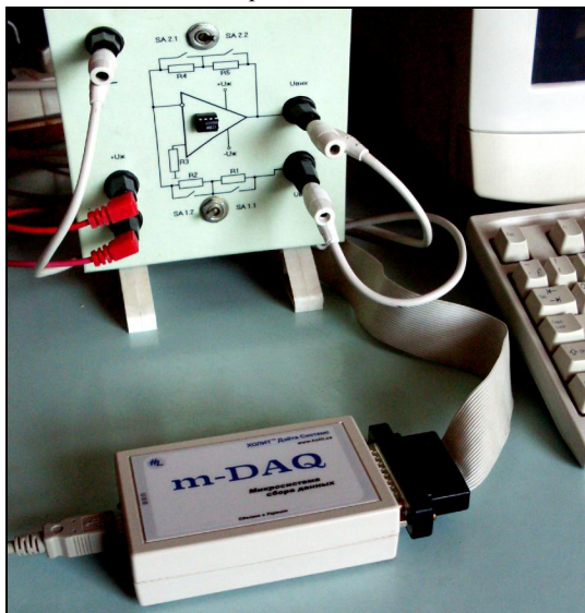
Рис. 3. Лабораторний комплекс на базі m-DAQ
