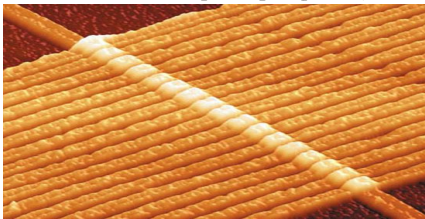
Рис. 4. Мемристорна матриця під мікроскопом
