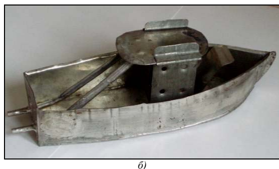
Рис. 3. Тепловий двигун із зовнішнім підводом теплоти: а) схема двигуна; б) його діюча модель: 1 – робочий циліндр, 2 – камера згорання, 3 – нагрівач, 4 – радіатор охолодження, 5 – водометні сопла, 6 – паропровід, 7 – корпус судна
