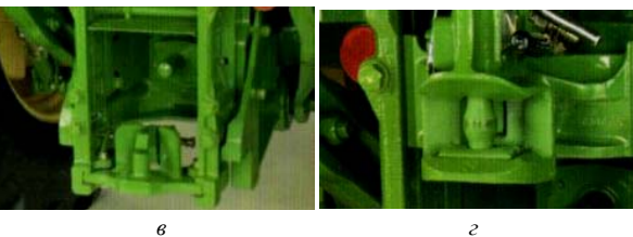
Рис. 1.6. Причіпні пристрої тракторів фірми John Deere серії 8030: а – з кульовим зачепленням, б – з гаковим захватом, в – з поршневим зачепленням, г – для вантажного візка
