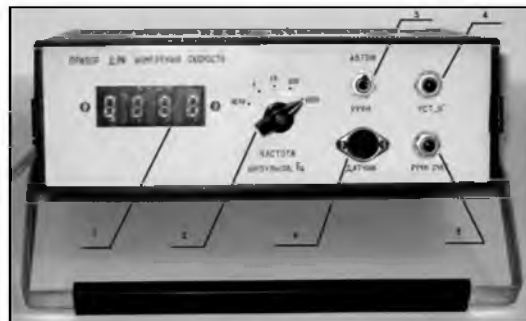
Рис. 1. Прилад для вимірювання швидкості: 1. Індикатор. 2. Перемикач частоти слідування імпульсів. 3. Перемикач режиму слідування імпульсів. 4. Кнопка установки лічильника в "0". 5. Кнопка рахунку в ручному режимі. 6. Гніздо для підключення
