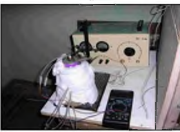
Рис. 5. Установа для визначення коефіцієнту теплопровідності: а – до теплоізолювання; б – після теплоізолювання.
