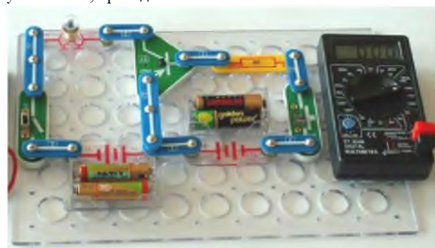
Рис. 5. Макет лабораторной работы по исследованию транзистора
