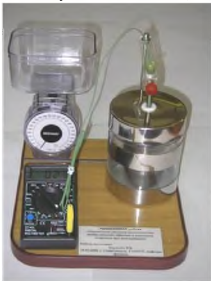
Рис. 3. Внешний вид установки по определению удельной теплоемкости металлических образцов и изменения энтропии при теплообмене
