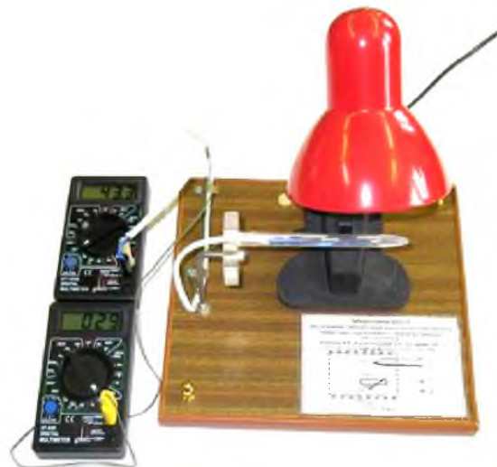
Рис. 2. Внешний вид установки по изучению температурной зависимости сопротивления термистора и определению его энергии активации
