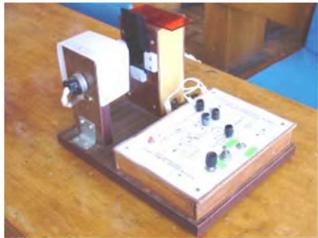
Рис. 6. Лабораторная установка для изучения внешнего фотоэффекта
