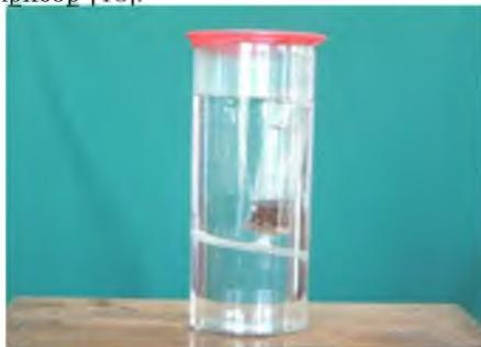
Рис. 6. Прибор для демонстрации реакций вытекающей и втекающей струй
