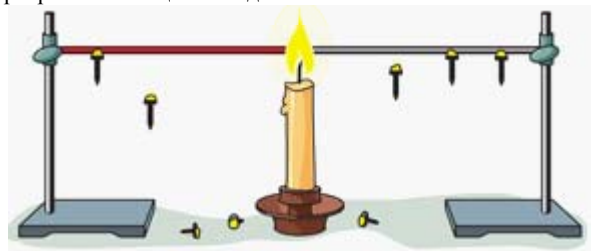
Рис. 1. Схема відомого зі шкільних підручників експерименту з порівняння коефіцієнтів теплопровідностей матеріалів
