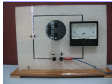
Рис. 3. Установки, для демонстрацій явища електромагнітної індукції, ефекту Холла, фотоэффекту
